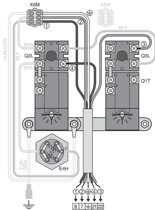
Schéma de câblage Ballon E.C.S. non solaire
